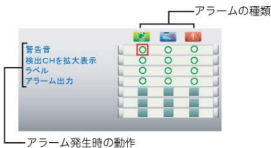
2. で“アラームの種類”と“アラーム発生時の動作”が交差する位置にカーソルを合わせ を押して各動作のON/OFFを設定できます
