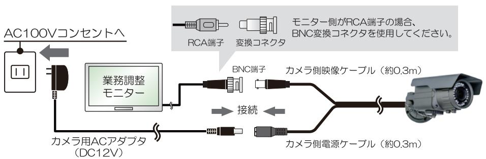
正しく電源が入るとカメラの映像がモニターに表示されます。
