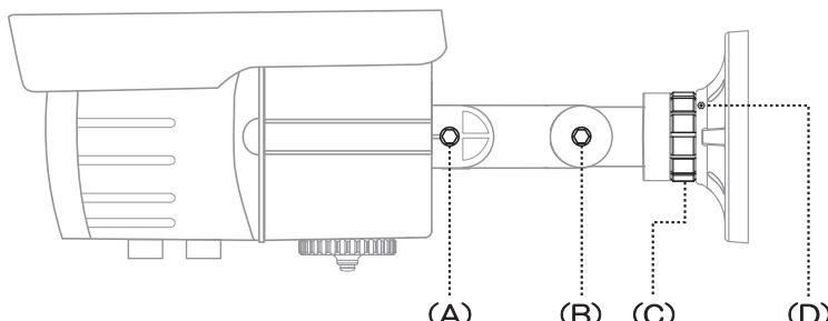
(A) 水平調整ネジ(付属の六角レンチで緩めてください)
