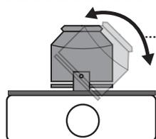
⑤最後に付属の六角レンチでカメラカバーを取付けます。（3箇所）
