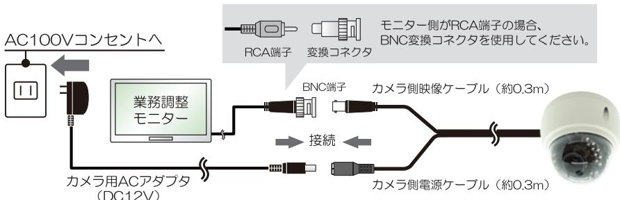
正しく電源が入るとカメラの映像がモニターに表示されます。
