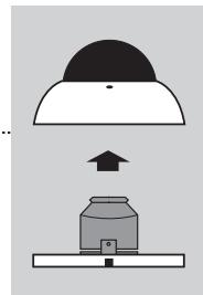
②プラケット部を天井（または壁）に4箇所ネジ止めします。
