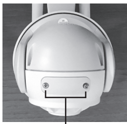
ネジ2箇所を外しカバーを外す
