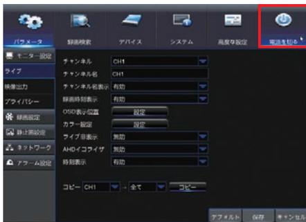
3. 中央に小さなウィンドウが表示されますので左下の「電源を切る」ボタンを選択します。
