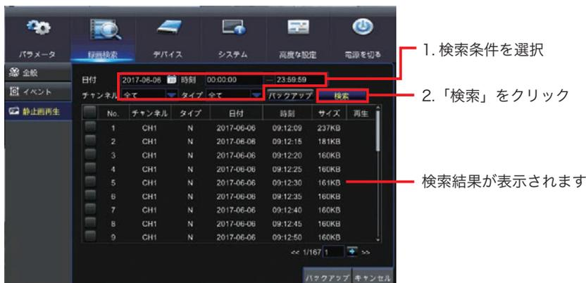
4. 検索に該当した録画データが一覧で表示されますので、再生したい録画データをクリックすると「再生」の列に「▶」マークが表示されますので「▶」にカーソルを合わせてクリックします。
