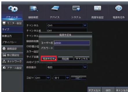
4. シャットダウンが開始され、完了すると完了した旨を伝えるメッセージが表示されます。
