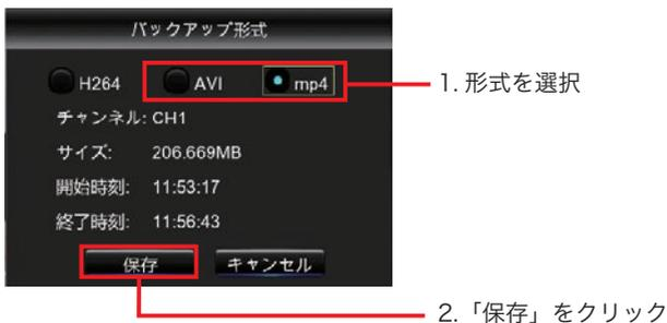
4. 保存先を選択する画面が表示されますので、画面左に表示されている「USB デバイス」をクリックして「OK」をクリックするとバックアップデータが保存されます。
