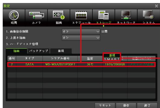
1. 表示されているハードディスク情報をダブルクリックします。
