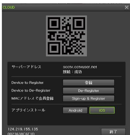
5. お使いのスマートフォンにアプリのインストールを行います。「アプリインストール」の項目からお使いのスマートフォンの OS に合わせて「Android」「iOS」のいずれかをクリックします。
