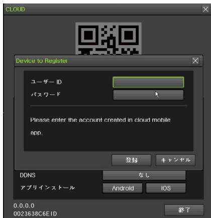
4. 「Device to Register」の「登録」をクリックして、先ほど登録したユーザー ID とパスワードを入力して「登録」をクリックします。「登録可能」と表示されたら設定は完了です。
