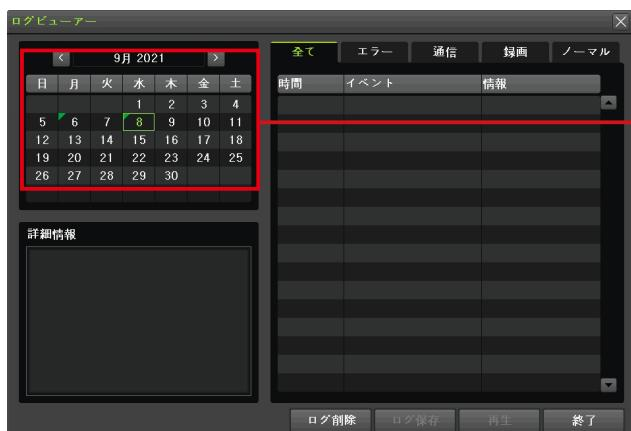
ログを表示したい「年」「月」を選択し日付をダブルクリックすると画面右側にログが表示されます。ログデータが存在する日は日付欄の左上に「▼」マークが表示されます。
