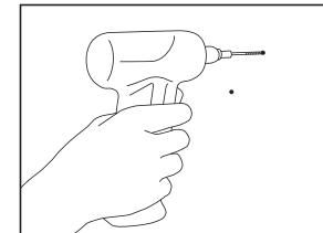
ネジ穴の印にドリルなどを使ってφ2mm程度の下穴を開けます。
