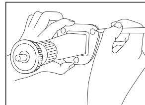
ブラケットを設置する場所にあて、ペンなどでネジ穴の印を付けます。
