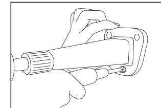
付属の取付ネジで、落下しないようにしっかりと固定します。
