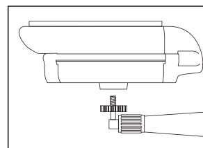
カメラ本体底のネジ穴にブラケットを取付けます。
