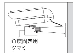
カメラの角度・向きを調整し、角度固定用ツマミを締めしっかりと固定します。
